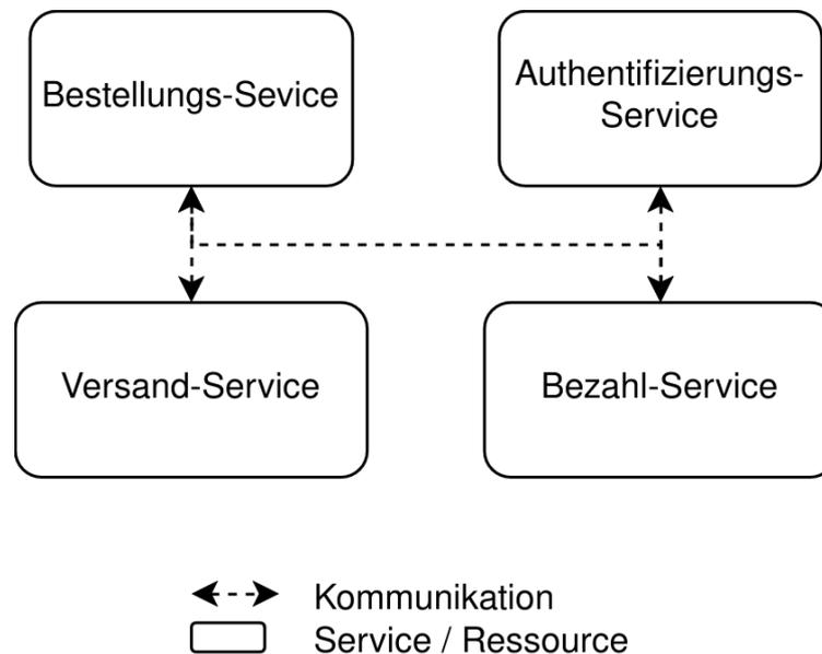
Abbildung 3.1.: Darstellung eines Systems, welches auf einer Service-Oriented Architecture beruht
