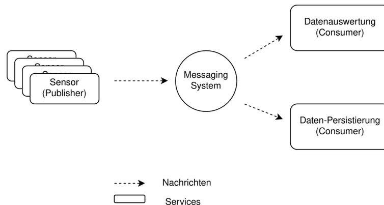
Abbildung 3.5.: Ein Beispiel für ein verteiltes System mit ein zentrales Messaging System
