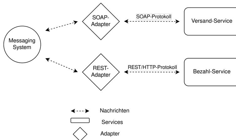
Abbildung 3.6.: Ein einfacher Enterprise Service Bus
