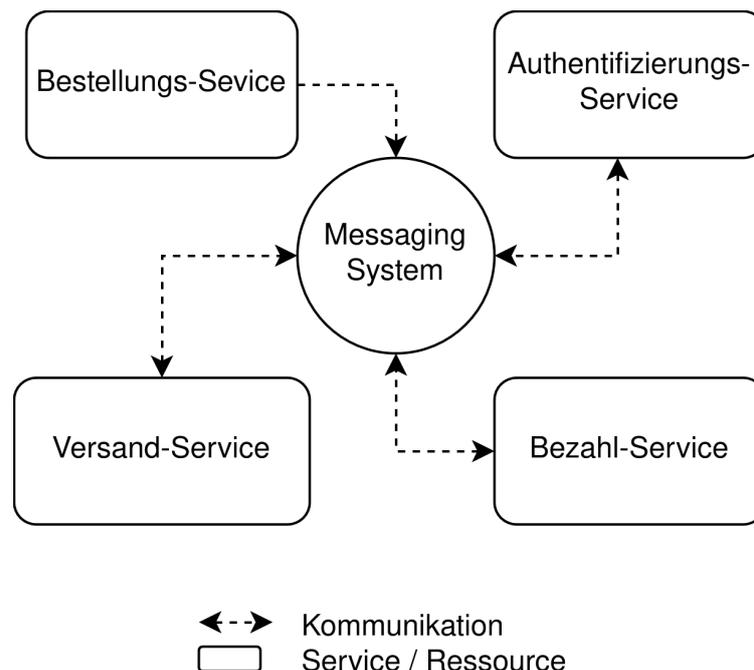
Abbildung 3.4.: Messaging System als zentraler Kommunikationsknoten
