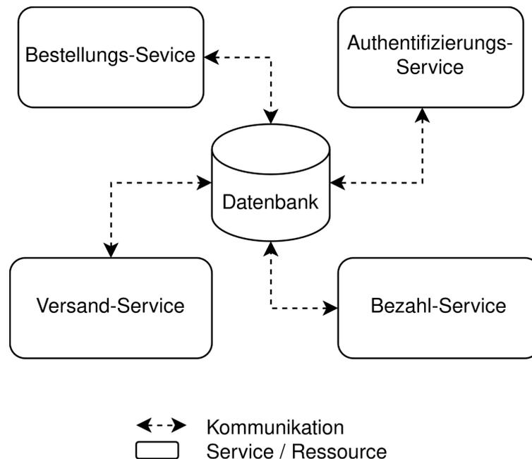
Abbildung 3.3.: System mit Datenbank als zentraler Kommunikationskomponente
