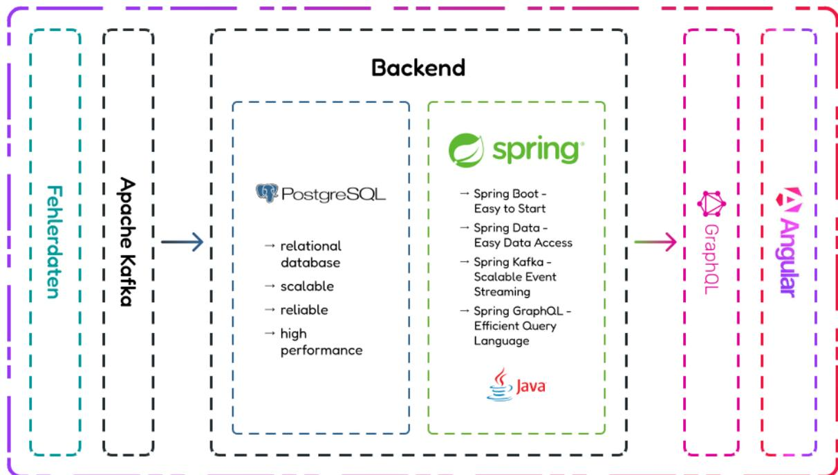
Abbildung 6.3.: Architektur unseres Prototyps mit Fokus auf das Backend
